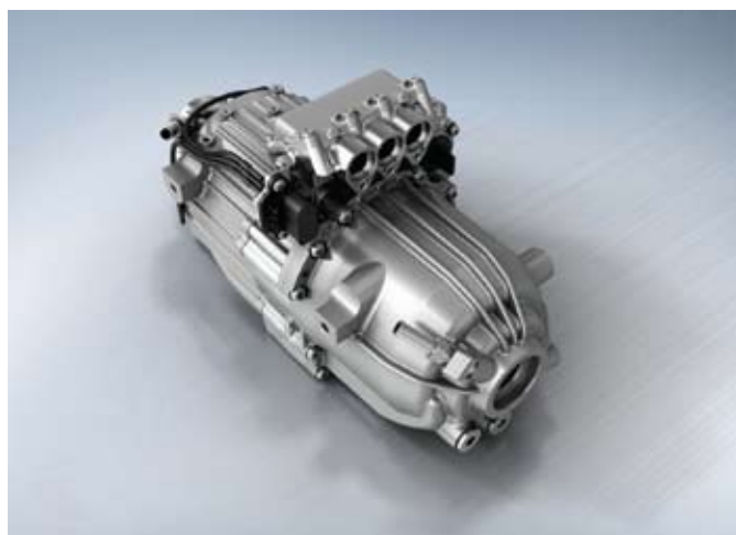
Villamos tengelyhajtómű a Boschtól hibrid és villamos járművek számára
