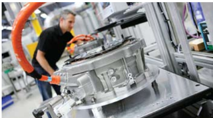
Elektromotorok sorozatgyártása a Boschnál
