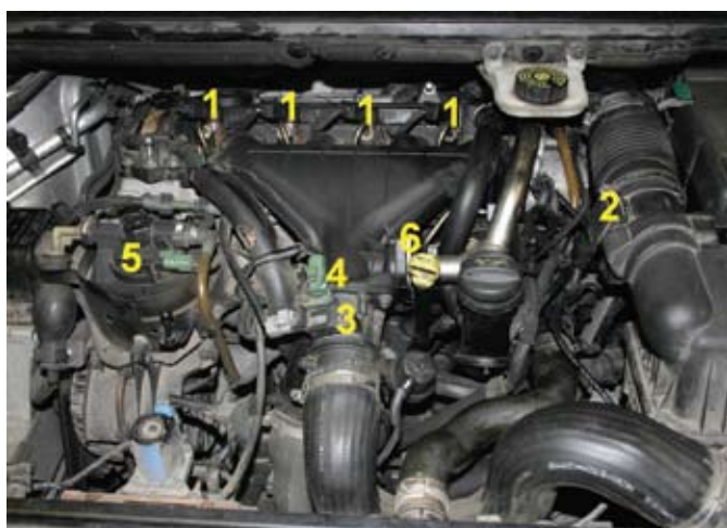
2. ábra: a műanyag motorborítás eltávolítása után néhány (a vizsgálat szempontjából) fontos alkatrész láthatóvá válik. 1: befecskendezőporlasztók 2: légtömegmérő 3: töltőnyomás-érzékelő 4: beszívott levegő hőmérséklet érzékelő 5: üzemanyagszűrő 6: EGR-szelepre csatlakozó cső
