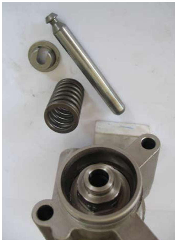
A nagynyomású szivattyú szerkezeti elemei: dugattyú (plunger), szivattyúház, rugó, rugótányér
