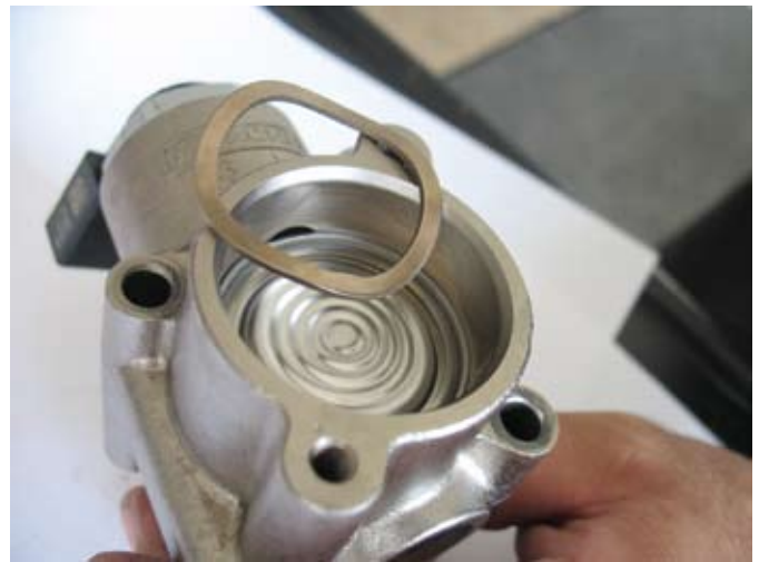
A szivattyú kisnyomású oldali tüzelőanyagtér második csillapító membráncellája
