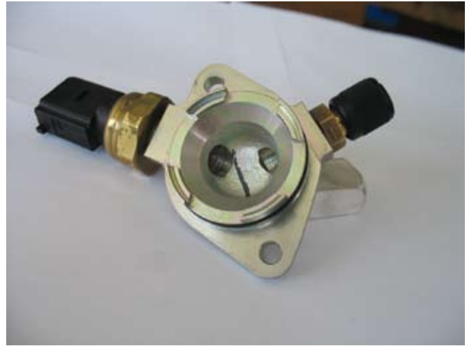
A szivattyú kisnyomású oldali fedele a tüzelőanyag-kamrával
