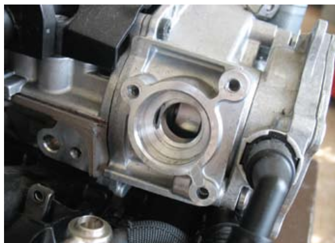
Nagynyomású szivattyú csatlakozóház. A szivattyúdugattyú-emelőtöke kiszerelt, a furatban a vezértengelyen található szivattyúbütyök látható
