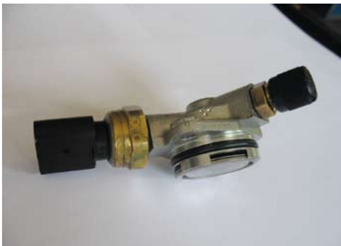
A szivattyú kisnyomású oldali fedele a nyomásjeladóval, a nyomásmérés csatlakozó szelepével és a nyomás-lengéscsillapító membránszelencével
