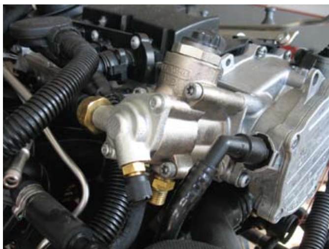
A nagynyomású szivattyú a hengerfejre szerelten. A nyíl a kisnyomású kör nyomásmérő-csatlakozójára mutat
