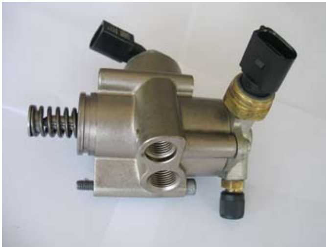
A kiserelt nagynyomású tüzelőanyag-szivattyú. Az alsó menetes furat a nagynyomású kilépő oldali csatlakozás
