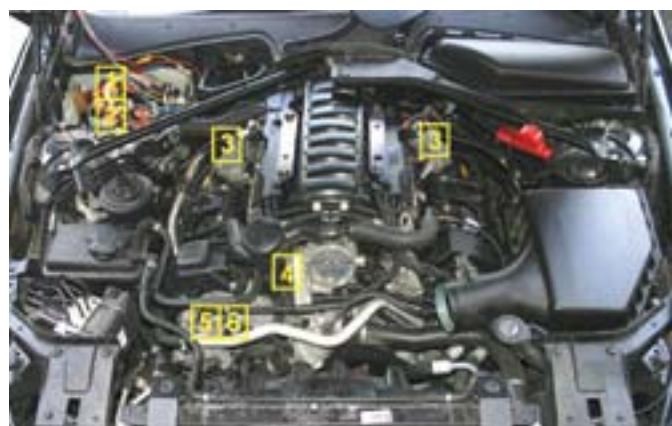
1. ábra: 1 – motormenedzsment ECU (Bosch Motronic ME 9.2.3), 2 – Valvetronic ECU, 3 – Valvetronic aktuátor, 4 – fojtószelepegység, 5, 6 – Vanos aktuátorcsatlakozók, jobb hengersor, a bal hengersoron ezek takarásban vannak
