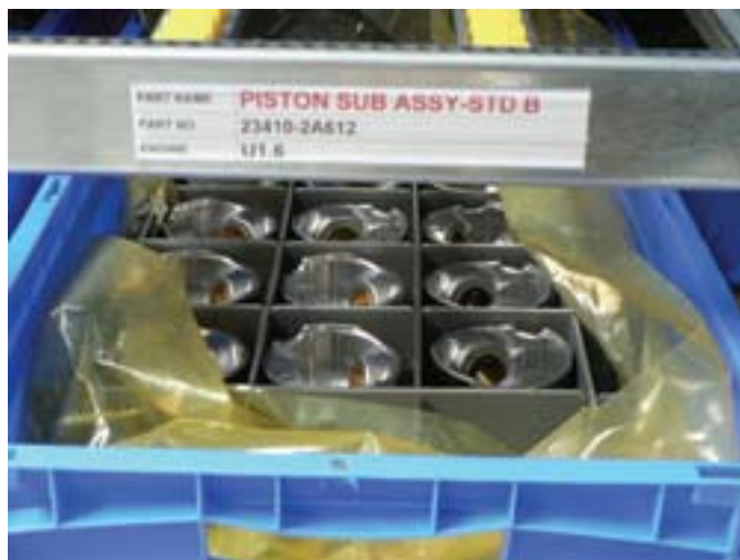
Új dugattyúk beszerelés előtt
