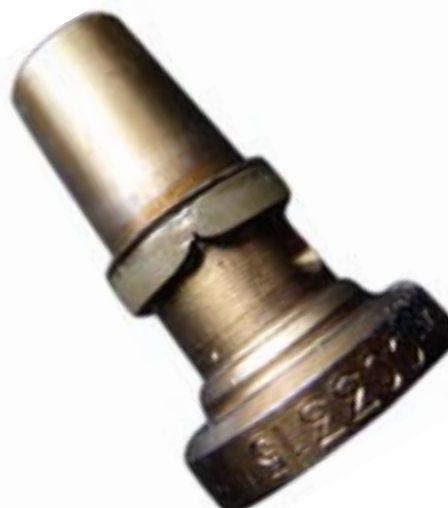
Vezérlőház külső tömítésének meghibásodása
