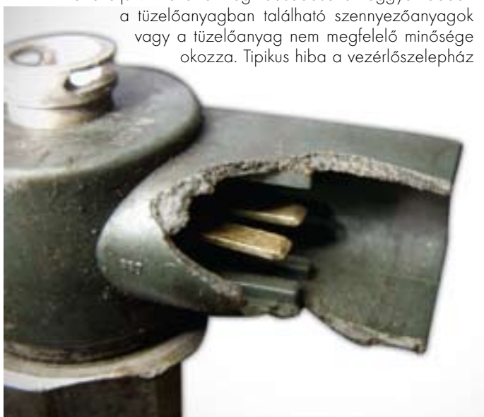
A tekercs elektromos csatlakozójának meghibásodása
