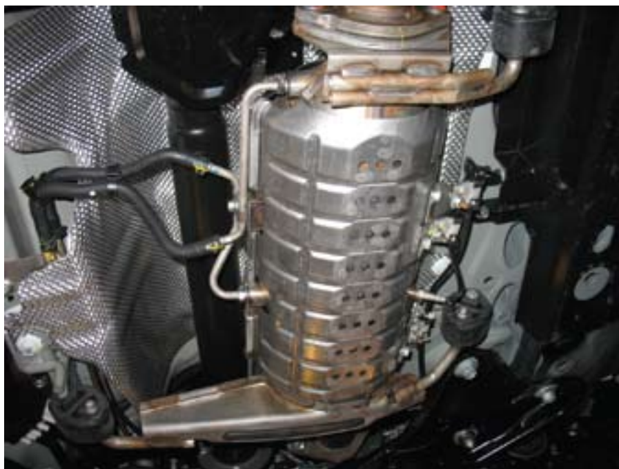
A DPF nyomáselvérteli helyeiről elmenő csövek, a kép jobb oldalán a DOC utáni hőmérő látszik
