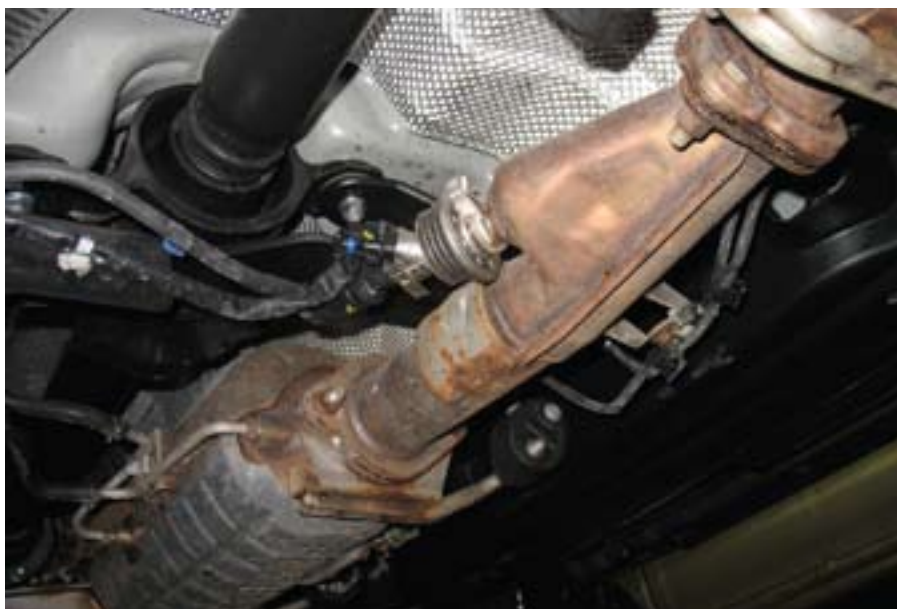
Az AdBlue folyadék mágnesszelepes porlasztója. A porlasztókamrában a nyomás 5 bar
