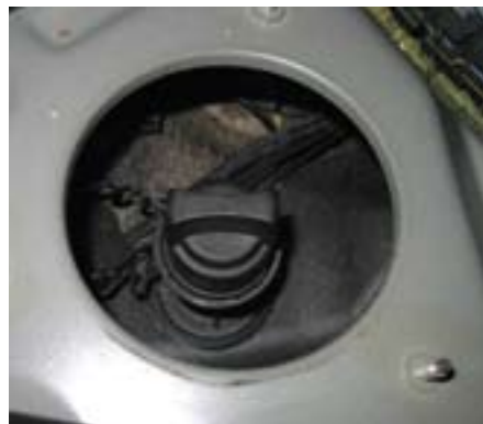
Az AdBlue tartály betöltőnyílása a csomagteréből érhető el egy jelölt fedél lecsavarozása után
