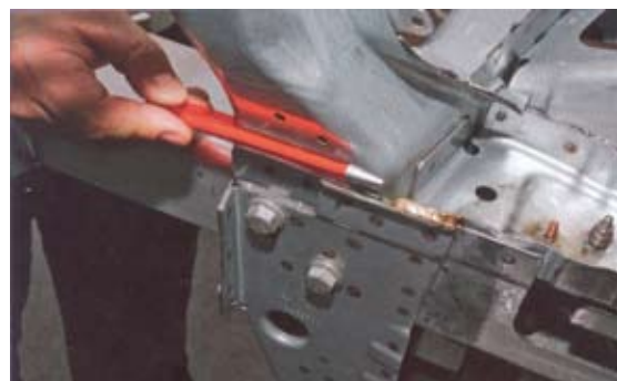
5. ábra: hossztartó rögzítése forrasztással
