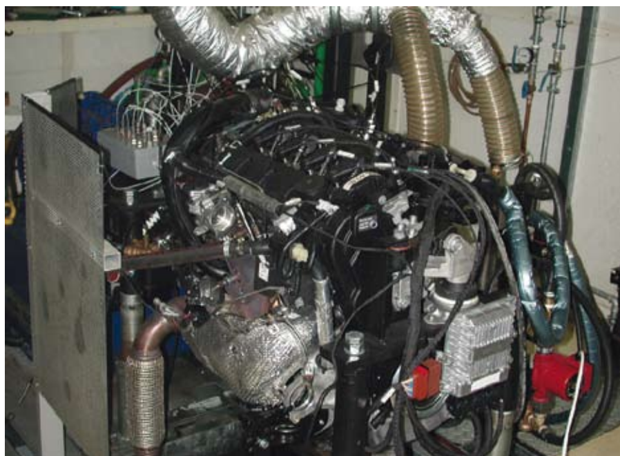
1. ábra: CEC DW10-es dízelmotor vizsgálati eljárása
