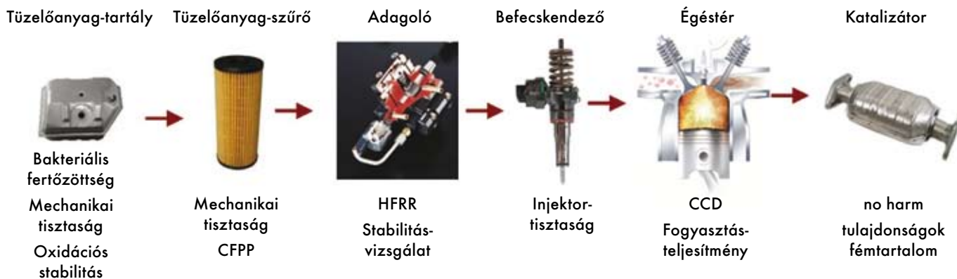
3. ábra: dízel tüzelőanyag minőségfejlesztés során vizsgált alkalmazástechnikai paraméterek
