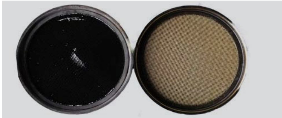
A DPF belépőkeresztmetszete tisztítás előtt és után
