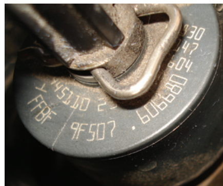
3. ábra: 1,8 TDCi motor gyári injektor kódcímkéje
