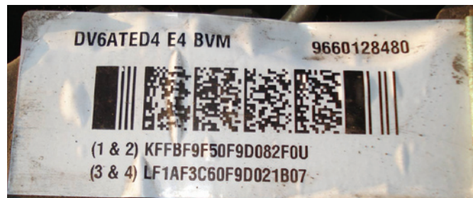
2. ábra: példa egy II. generációs Bosch Focus 1,6 kódcímkéjére
