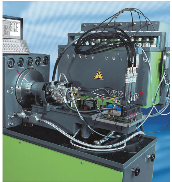
3. ábra: EPS 815 típusú kísérleti munkapad beszerelt VP-szivattyúval, a tesztelés időszaka alatt (forrás: Bosch)
