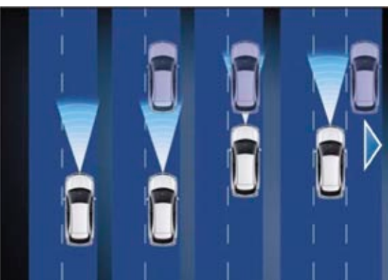
Jármű menettengelyének meghatározása és a kalibrálási pont meghatározása a jármű első radarjának beállításához
