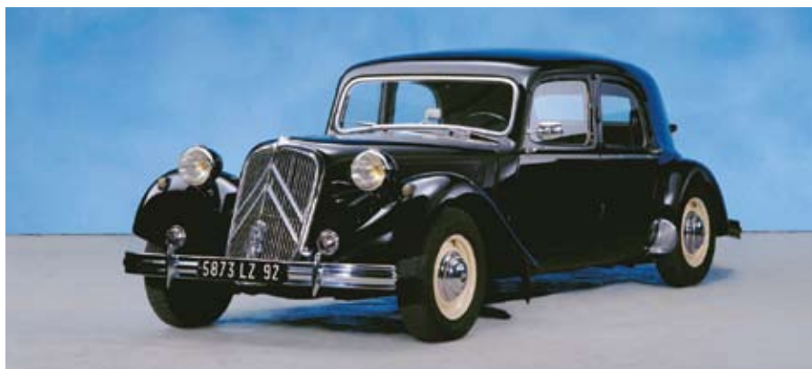
Traction Avant – a világ első önhordó acélkarosszériás, elsőkerék-meghajtású autója!
