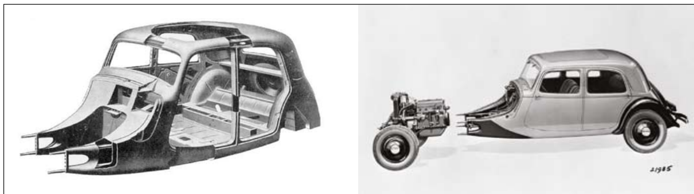
A Traction önhordó fémkarosszériája (másnéven „monocoque” vagy „unibody”)
