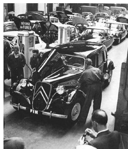
Traction Avant – a világ első önhordó acélkarosszériás, elsőkerék-meghajtású autója!
