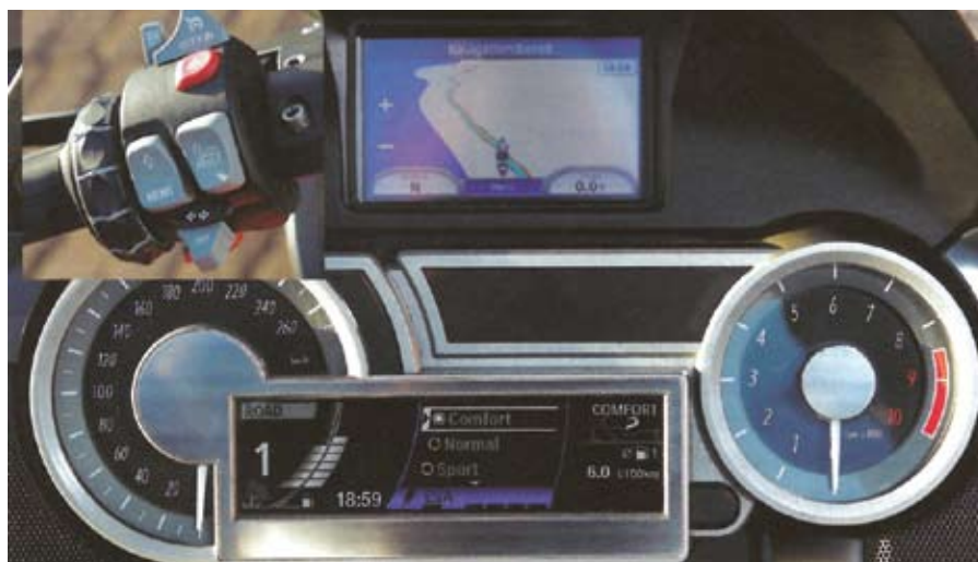
3. ábra: a műszerfal a színes kijelzővel és bal oldali markolat a Multi-Controllerrel
