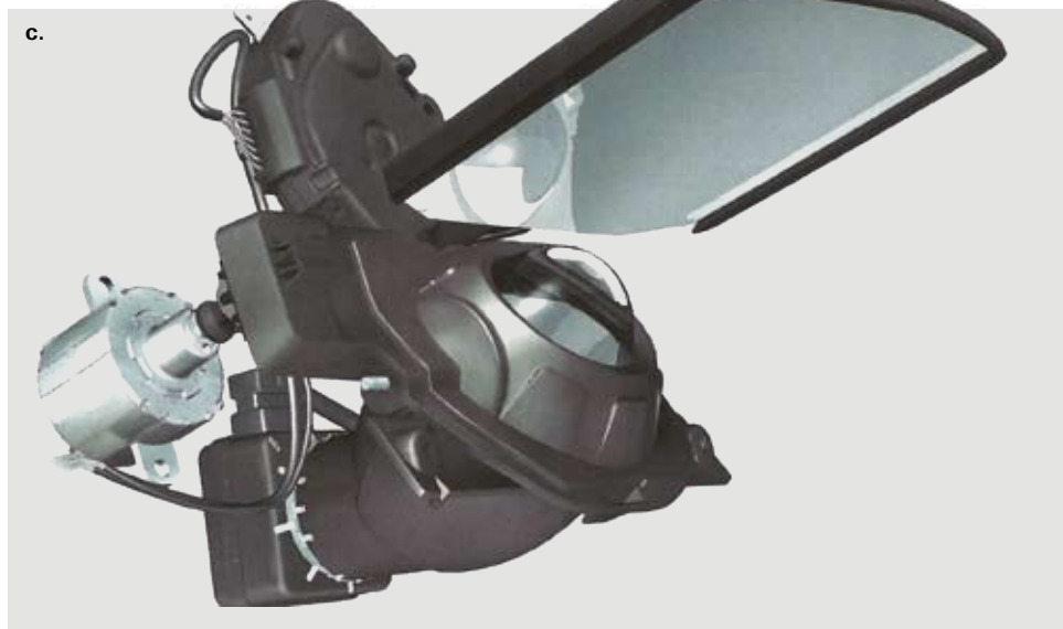
2. ábra: (a) a kanyarfény által jobb a kanyar megvilágítása (alul), mint hagyományos fényszóróval (felül); (b) A forgó tükör küszöbölí ki a motorkerékpár dőlését; (c) Az adaptív kanyarfény komponensei: xenonprojektor reflektálótükörrel
