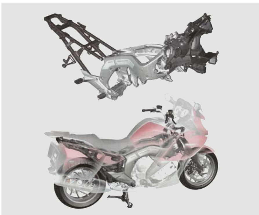
1. ábra: a nyers váz felül és a motor röntgenképe alul
