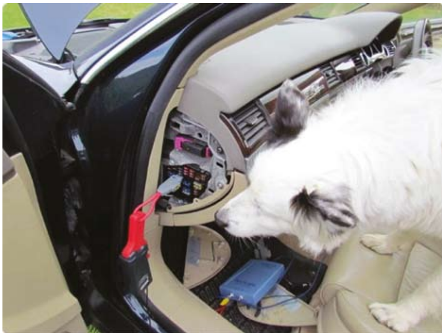
2. ábra: 60 A-es lakatfogó bekötése a biztosíték helyére betett mérőhurok segítségével
