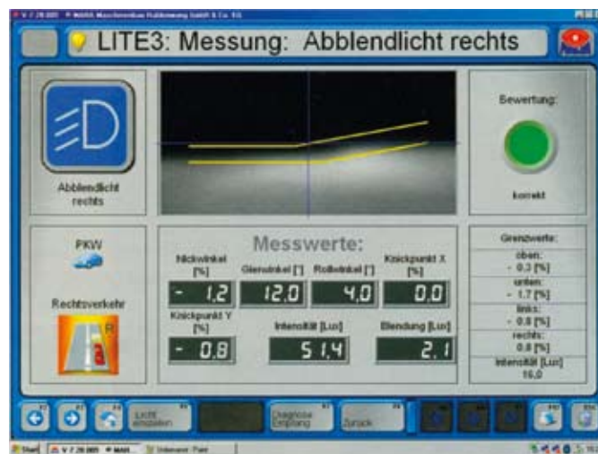
Jobb oldali tompított fény beállítása megfelelő (kép a monitoron)
