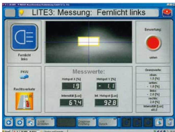
Bal oldali távfénybeállítás nem megfelelő, lefele hord (kép a monitoron)
