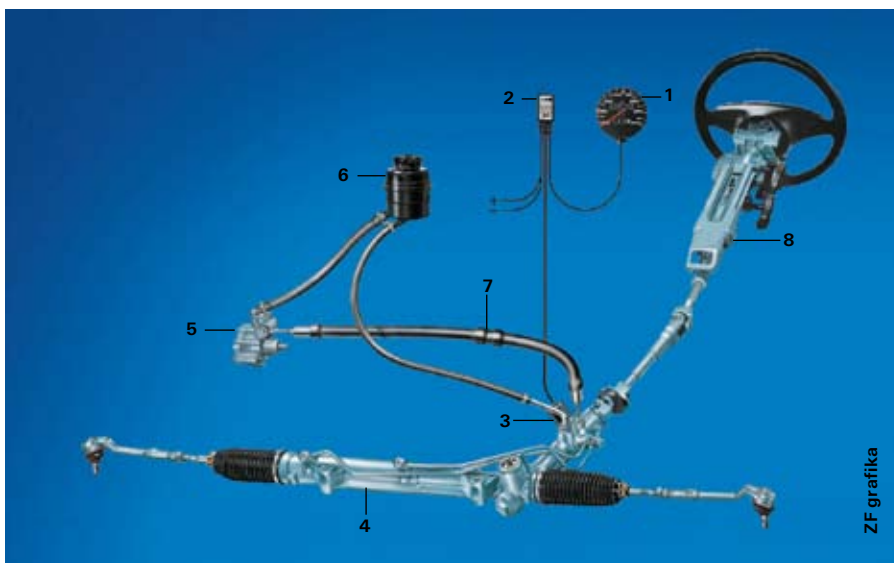
1. ábra: 1 – sebességjel a műszerfalból, 2 – vezérlőelektronika, 3 – elektrohidraulikus szelep, 4 – fogasléc kormánygép, 5 – szervoszivattyú, 6 – olajtartály, 7 – flexibilis, hidraulikus lengéscsillapító csővezeték, 8 – kormánykerék-állító mechanizmus
