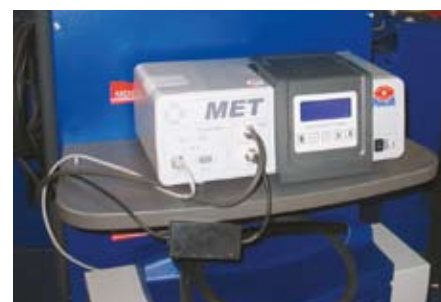
A dízelmotor-részecskekibocsátás új mérőműszere a MAHA MET 6.2. A műszerrel a részecskeemisszió tömegárama is értékelhető
