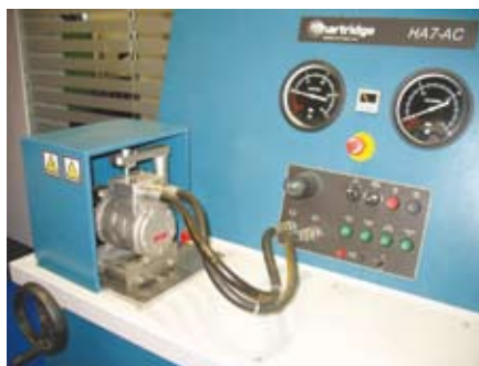
A Hartridge cég HA7-AC klímakompresszor próbapadja, melyet klímászerelő, -javító műhelyeknek ajánlanak. A DENSO jóváhagyásával már rendelkezik
