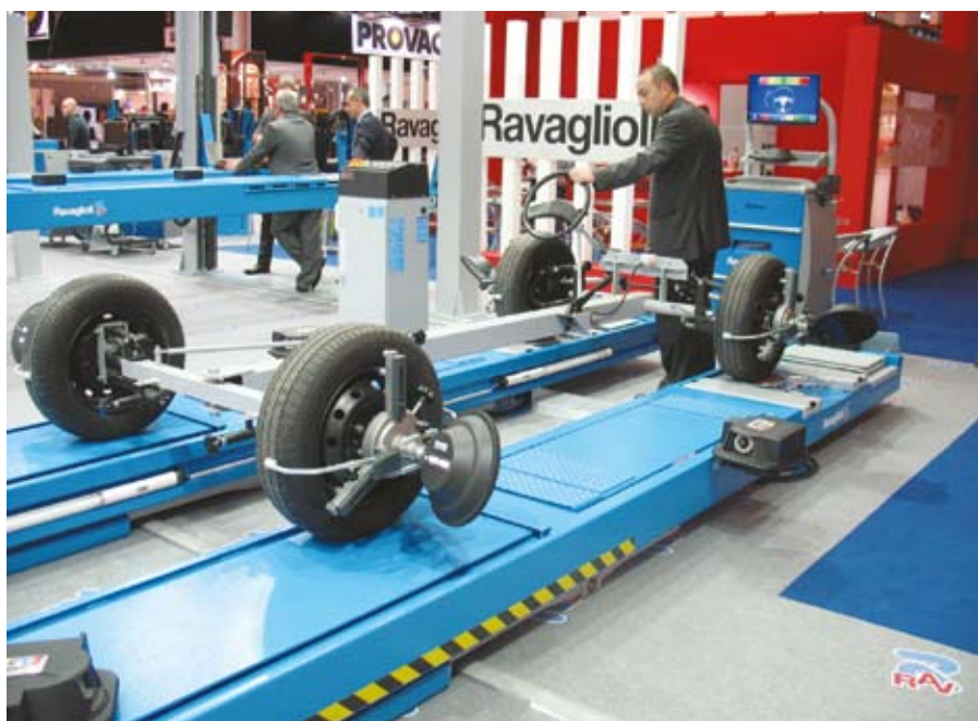
A járműoldalanként egy mérőmodult használó futóműmérő technológiát több gyártó is alkalmazza, a Bosch-Beissbarth után a Ravaglioli is bemutatta mérőműszerét
