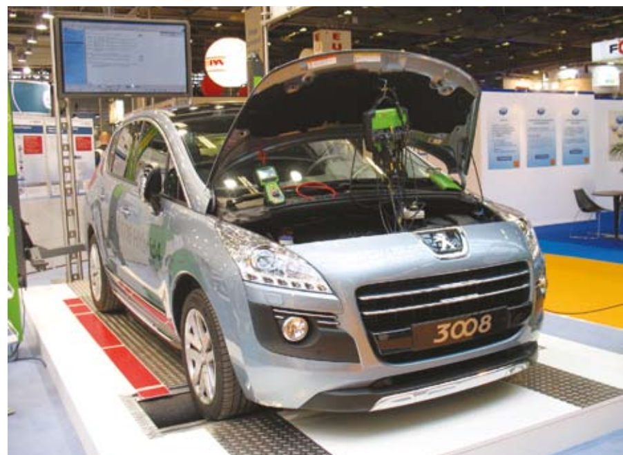
A Bosch standján, görgős fékerőmérő padon áll a Peugeot 3008 HYbrid4, mely alatt a Bosch „Axle Split Hybrid” technika rejtőzik. Az autó vizesárkában, bal oldalon az FSA 050 EV multimétert látjuk. Mind a hibridhajtást, mind a műszert vásári nagydíjra nevezték
