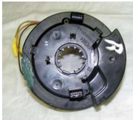
2. ábra: szöghelyzetjeladó és légszákspirál összeszerelve. Megfigyelhetők a középről kitört darabok és a két lyuk, ahol a csavarok rögzítik
