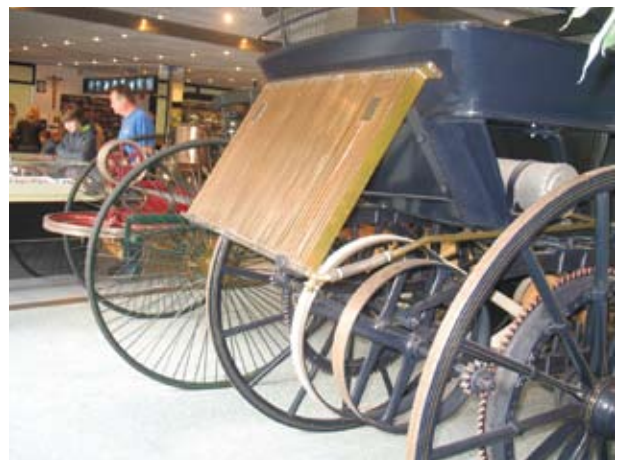
A Daimler Motorwagen (Motorkutsche) az első négykerékű automobil, a ló nélküli kocsit Wilhelm Wimpff neves stuttgarti kocsigyártó építette, melynek kormányzásához az első tengelyt kellett elfordítani. Motorja Daimler ún. állóóra motorja volt (1 henger, 469 cm 3 , 1,5 LE). Szíjhajtása már kétfokozatú hajtást, „sebességváltást” tett lehetővé. Maximális sebessége 16 km/h.
