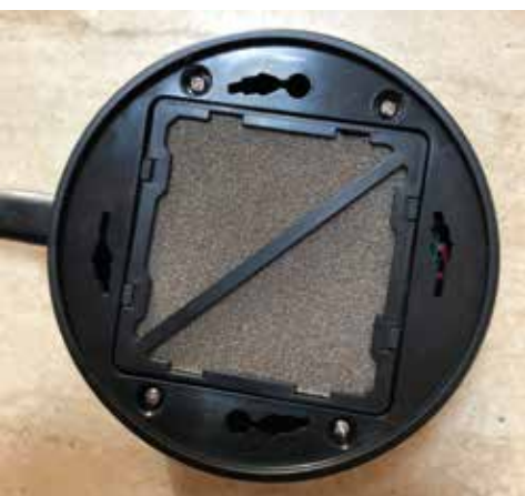
A titán-dioxiddal bevont katalizátorhordozó lemez az AirZing™ Mini készülékben
