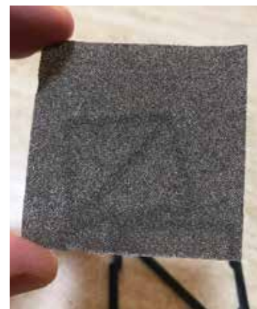
A tartókeretből kiemelt katalizátorhordozó lemez (nem szűrőlap!)
