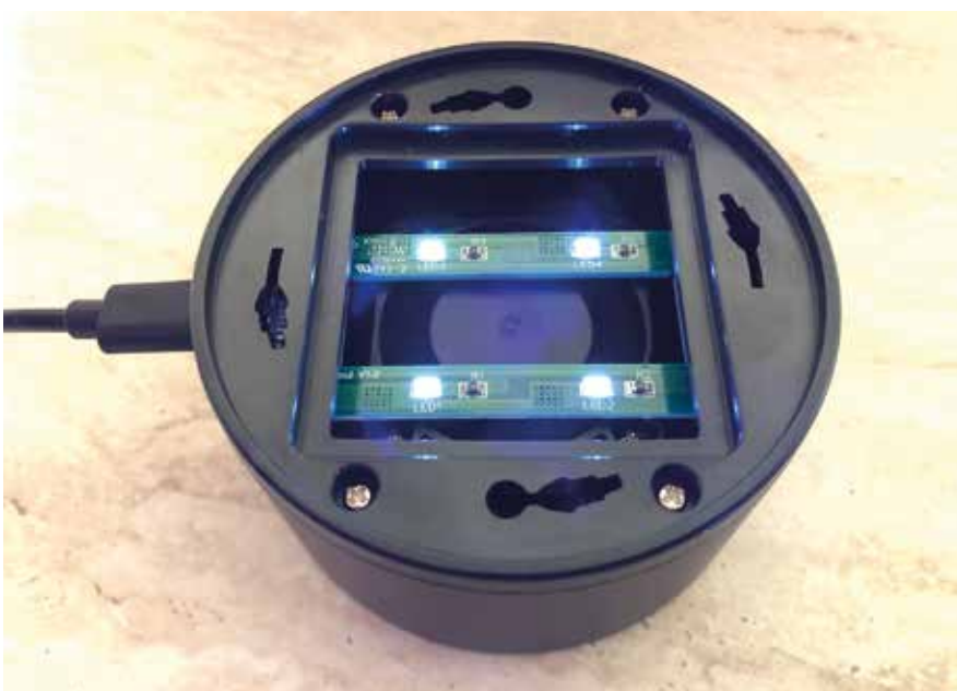
Az UV LED-ek elhelyezése a készülékben
