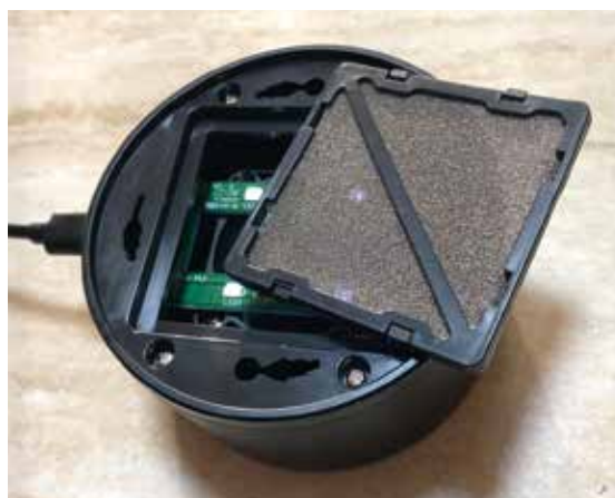
A katalizátorhordozó lemez kiemelése tisztításhoz
