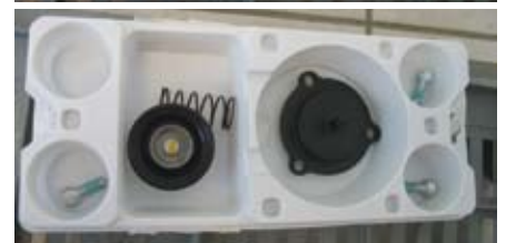
4. ábra: javítókészlet pneumatikus működtetésű recirkulációs szelephez (Opel 2,0 L, Z20LEH turbo ecotec)
