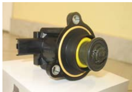
3. ábra: Pierburg elektromos recirkulációs szelep (Mini Cooper 59007116003, turbószám: 53039880146)
