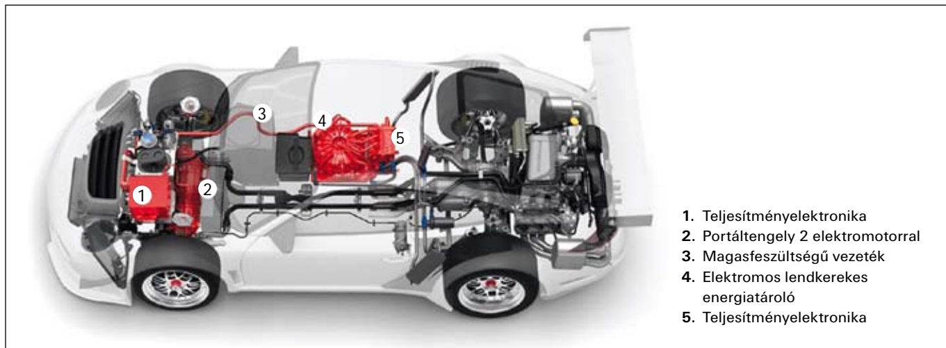
1. ábra: Porsche 911 GT3 R Hybrid – rendszeráttekintés
