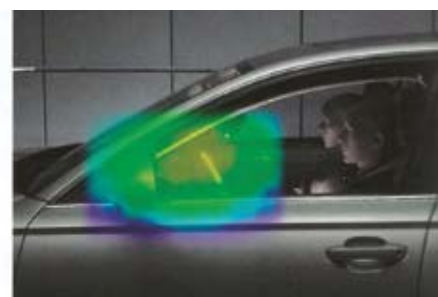
A visszapillantó tükör zajkeltése, jobbra a végső kialakítás
