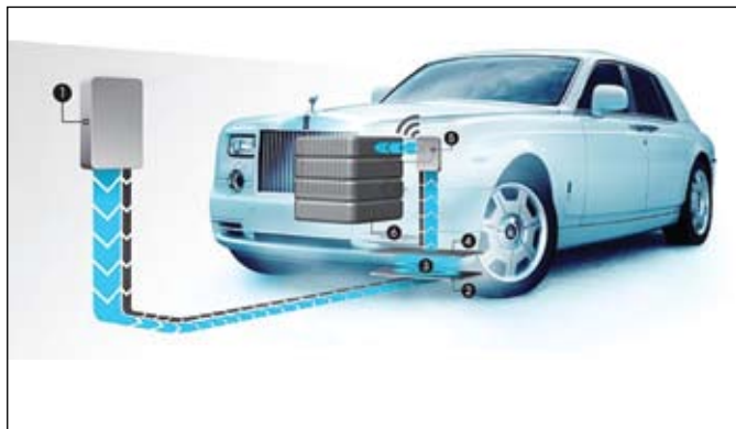
Ma már a Rolls-Royce-nak is van villamos változata. A kísérleti Phantom 102EX akkumulátorait induktív rendszer tölti. Főbb részei és felépítése. 1. Tápegység; 2. Primer tekercs; 3. Mágneses erőtér; 4. Szekunder tekercs; 5. Vezérlőegység; 6. Nagyfeszültségű akkumulátor
