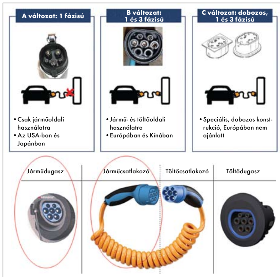
Töltőegységek legfőbb csatlakozó- és dugaszváltozatai, alkalmazásuk
