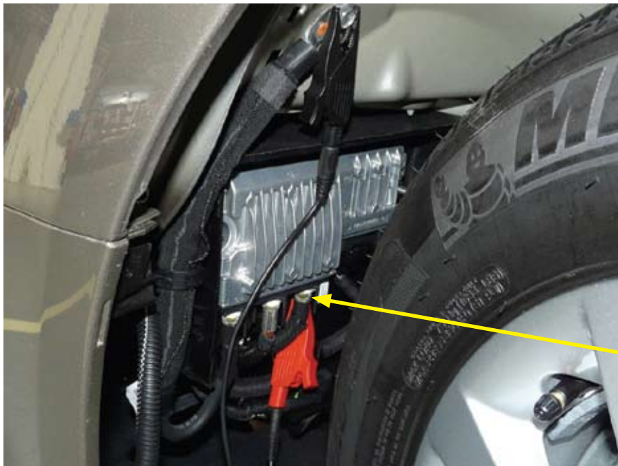
9. ábra: az UCAP kondenzátort célberendezéssel kell kisütni, a kisütési idő max. 5 perc
