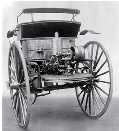
A Patent-Motorwagen első sorozatban gyártott változata 1888-tól. Az 1,5 lóerős motorral 16 km/h sebességet lehetett elérni, akkori ára 3000 márka volt
