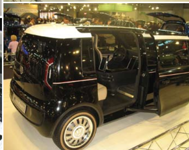
VW e-motion – „Vienna Taxi”. A villanytaxi 45 kWh-s Li-ion akkumulátora 300 km-es hatótávolságot tesz lehetővé városi üzemben. Elektromos motorja 85 kW (csúcs), 50 kW (tartós) teljesítményű.
