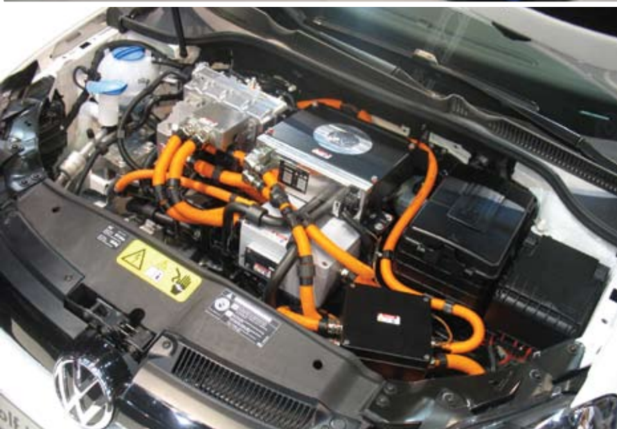
VW e-motion – „Vienna Taxi”. A villanytaxi 45 kWh-s Li-ion akkumulátora 300 km-es hatótávolságot tesz lehetővé városi üzemben. Elektromos motorja 85 kW (csúcs), 50 kW (tartós) teljesítményű.
