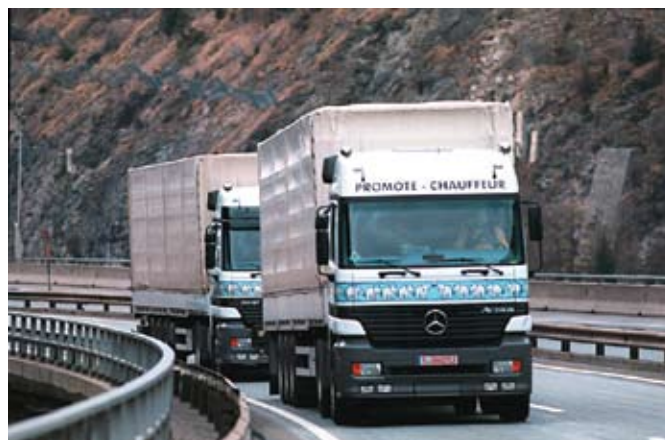
Konvojvezetés (platooning) Európában: egymást szorosan követő tehergépkocsikkal, bennük ülő, de a járművet nem vezető sofőrökkel
