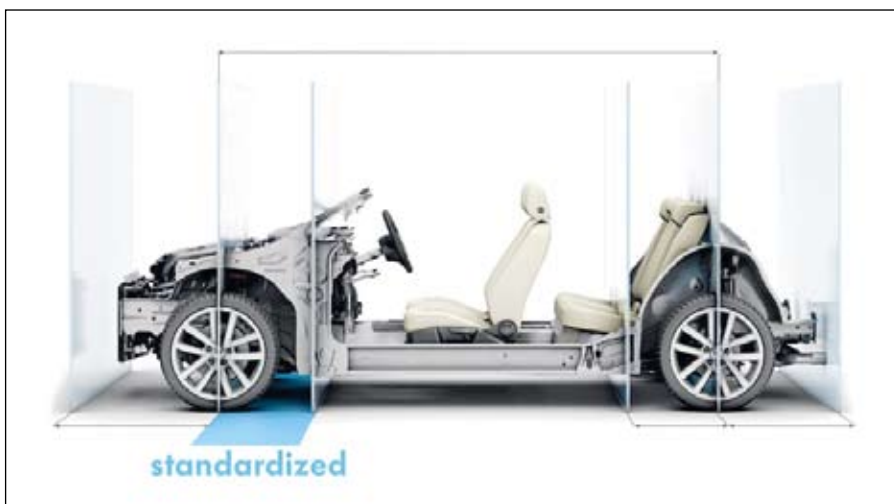
1. ábra: az MQB-rendszer közös műszaki alapja az első kerék középpontja és a pedál érintési pontja között van
