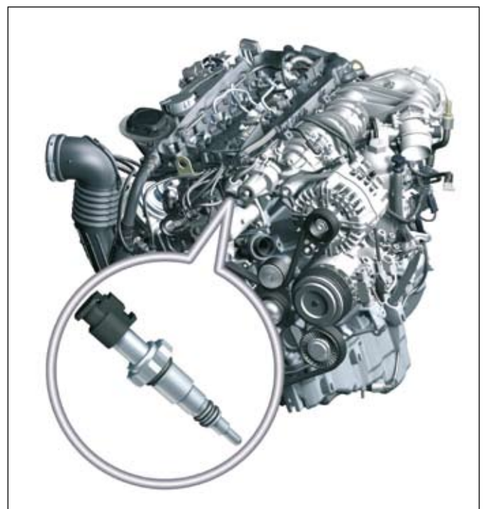
7. ábra: hűtőfolyadék-hőmérséklet-szenzor és elhelyezkedése a motoron
