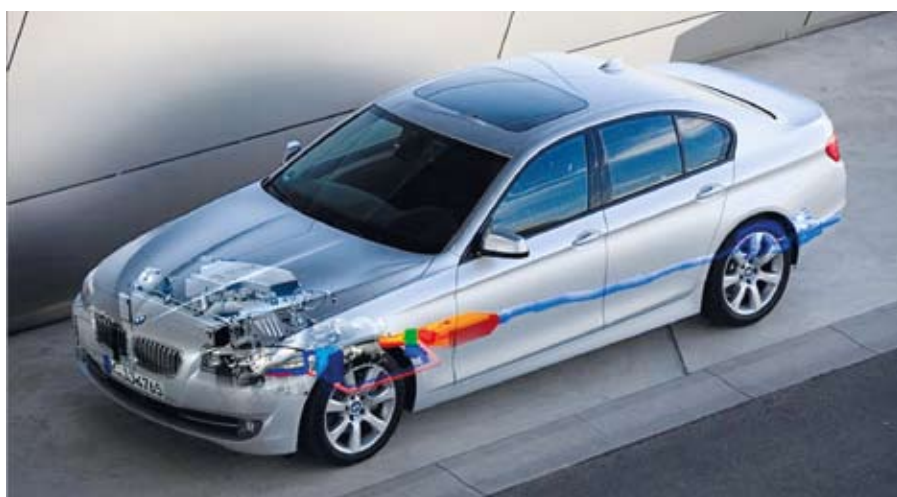
A BMW termogenerátorát a kipufogócsőbe kötötték, és ...
