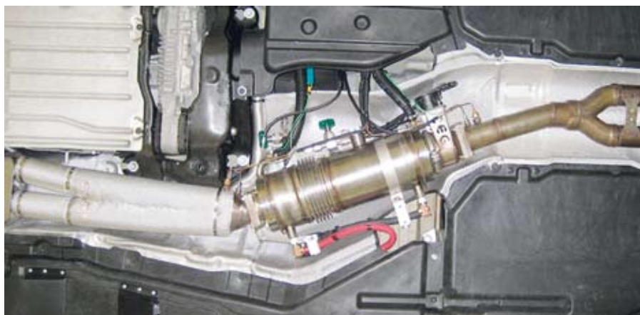
A BMW termogenerátorát a kipufogócsőbe kötötték, és ...
