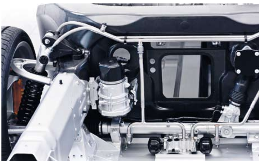
1. ábra: a Tenneco Kinetic beépítése a McLaren MP4-12C-ben
