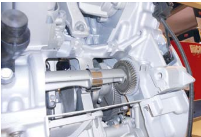
9. ábra: az előddel ellentétben az N47 kiegyenlítő tengelyeit a forgattyús házba integrálták
