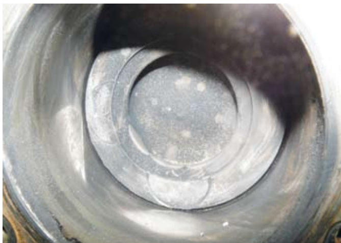
1. kép: a szívószelepek nyoma a dugattyúban
