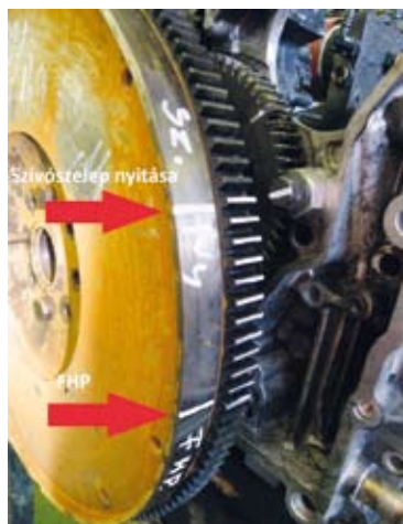
5. kép: szívószelep nyitási pontja
