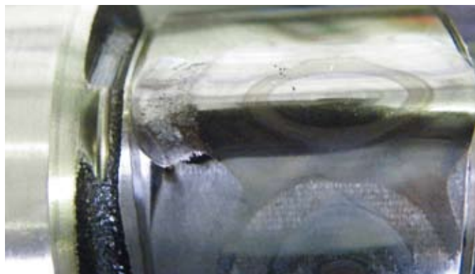
11. kép: kopott vezérműtengely
