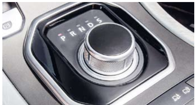
Az Audik és a BMW-k forgó funkcióválasztói egyszerűbbek, kisebb helyigényűek, és jóval megbízhatóbbak a nyomógomboknál. Ennek megfelelően kisebb gépkocsikon is mind szélesebb körben használják
