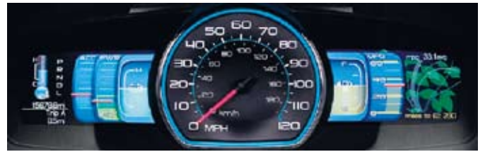
A Ford Fusion/Mercury Milan, SmartGauge (intelligens műszer) elnevezésű tervezési díjjal elismert műszerfalán folyadékszint jelzi az akkumulátor és a benzintartály telítettségét; mutatók a gyorsítást, a villamosenergia-tartalékot és az átlagos üzemanyag-fogyasztást
