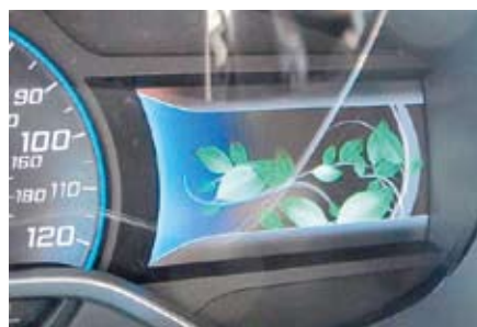
A SmartGauge, sebességmérőtől jobbra látható falevelek száma a takarékos napok számát jelzi
