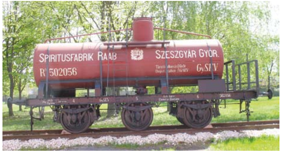
A Vagongyár első gyártmánya 1897-ben 30 db 15 tonnás, kéttengelyű tartálykocsi volt a Galícia-Kárpát Petróleum Rt. részére. Két éven belül, 1898-ban elkészült az 1000. vasúti kocsi
