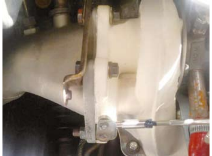
Magyar technológiával készült leömlő és angol bevonattal készült turbóház találkozására
