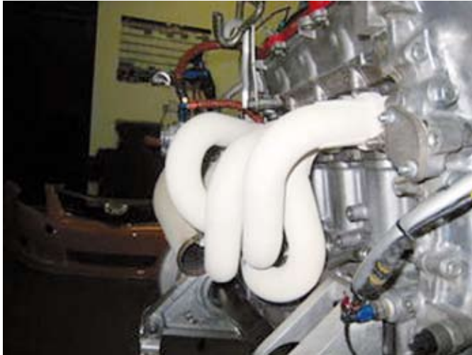
Zircotech technológiával felvitt bevonat nagy teljesítményű motorokhoz
