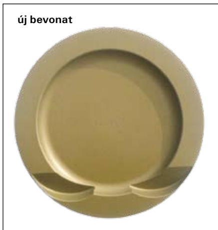
Versenyautó motorjának bevonatolt dugattyútetője
