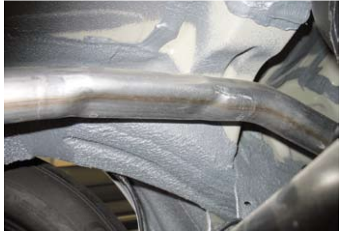
Az ellapított csőszakaszt a futómű-berugózás helyigénye indokolja
