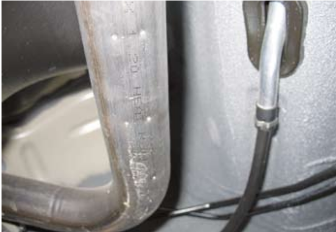
A vágási hely jelölése a kipufogócsövön
