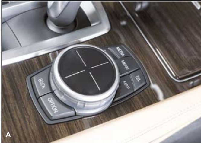
A. A BMW 7 iDrive kapcsoló tapintásérzékeny fedőlapja. Használatával, az ujjal rárajzolt/ráírt jel akkor is az utasításrendszerbe vihető, ha az történetesen kínai írásjel. Ez bizonyosan vevőkörbővülést helyez kilátásba a jármű kínai vásárlóinak körében
