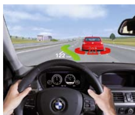
A legújabb, második generációjú HUD-okban lézersugár vetíti a látómezőbe a szükséges információkat, ami jobban látható, élesebb rajzolatú képmegjelenítést tesz lehetővé
