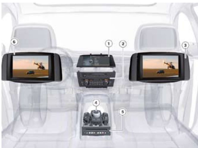
A hátsó ülésen utazók tv-közvetítést is nézhetnek. 1 – Első vezérlőegység. 2 – Hátsó vezérlő. 3, 6 – A hátsó ülés előtti képernyők. 4 – Csatornaváltó. 5 – Finombeállítók
