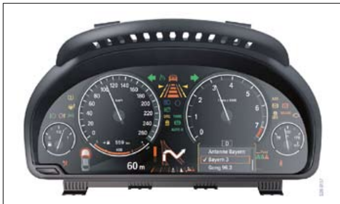
Járműveink jellegzetes kombinált műszerfalán, a lehetséges 25–30 képi információ közül 10–15 folyamatosan látható
