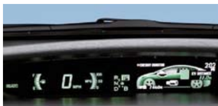
A hibrid járművek műszerfalának szemléletes eszköze a pillanatnyi energiaáramlás animációja és...
