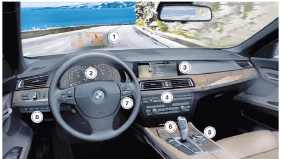
A BMW 7-es F01/F02 modellváltozatának korszerű műszerfala és működtetői. 1 – Head-up display. 2 – Kombinált műszerfal. 3 – Központi információmegjelenítő. 4 – Az egyéni beállítások kezelőszervei. 5 – Kontroller. 6 – Az automatikus sebességváltó előválasztó karja. 7 – A kormánykerék és a kormányoszlop kezelőszervei. 8 – A vezetői asszisztensek működtetőgörgőnumai
