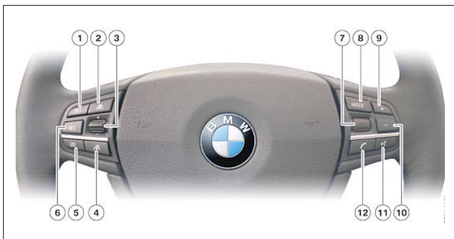
Kormánykerék-nyomógombok. 1 – Sebességtartó beállítógombok. 2 – Távcsökkentő gomb. 3 – \pm Sebesség-állító gomb. 4 – Távnövelő gomb. 5 – Áramváltó gomb. 6 – A tárolt sebesség megjelenítőgombja. 7 – Rádióállomás-választó kerék. 8 Hangjelzés-állító gomb. 9 – Hangerőnövelő. 10 – Hangerőcsökkentő. 11 – Kihangosítógomb. 12 – Telefonkapcsoló gomb
