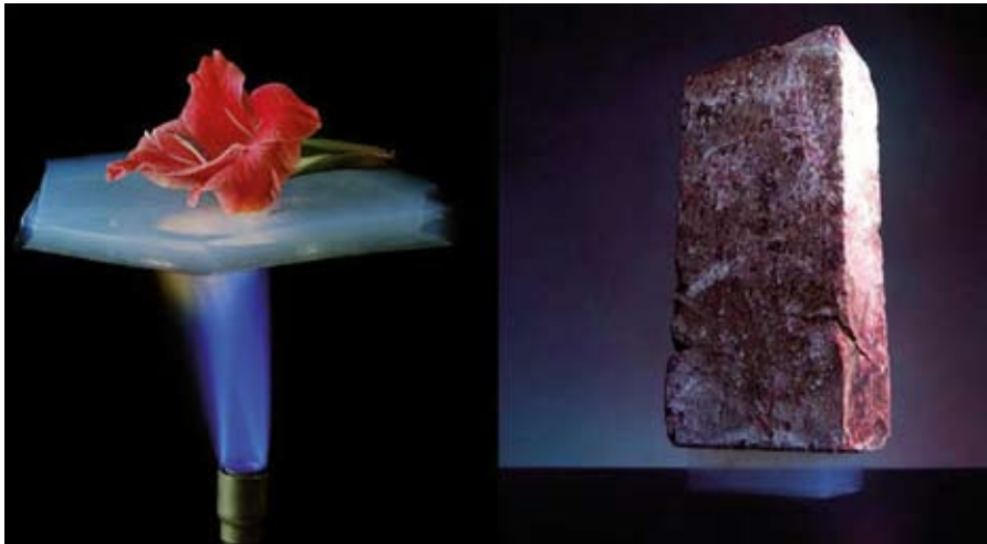
3. ábra: a szilika aerogélek tulajdonságai rendkívül változatosak lehetnek: kiváló hőszigetelők, ha kell, szilárdak, ha kell hajlékonyak (Forrás: NASA)
