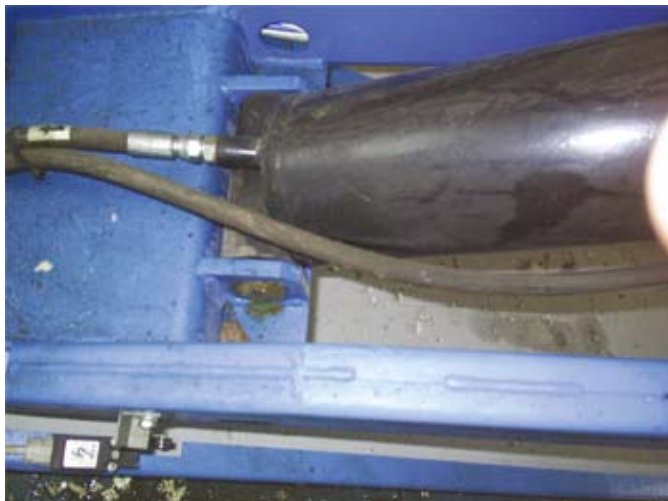
1. kép: ollós emelő munkahengere (teher tartó szelep nélkül) és az alsó végálláskapcsoló
