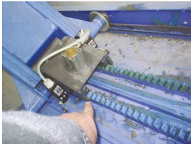
2. kép: az emelőkar akaratlan elmozdulása elleni rögzítő szerkezet az ollós emelőn (ez az előző hiányában alapvető fontosságú)
