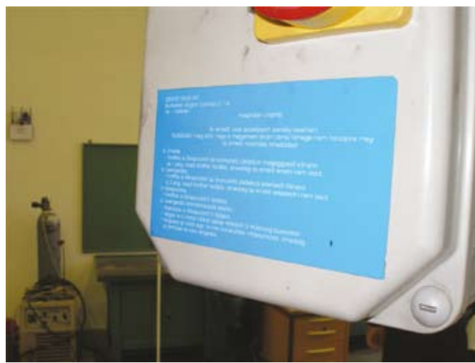
4. kép: csápos emelő főkapcsolószerkevénye a rövidített kezelési utasítással
