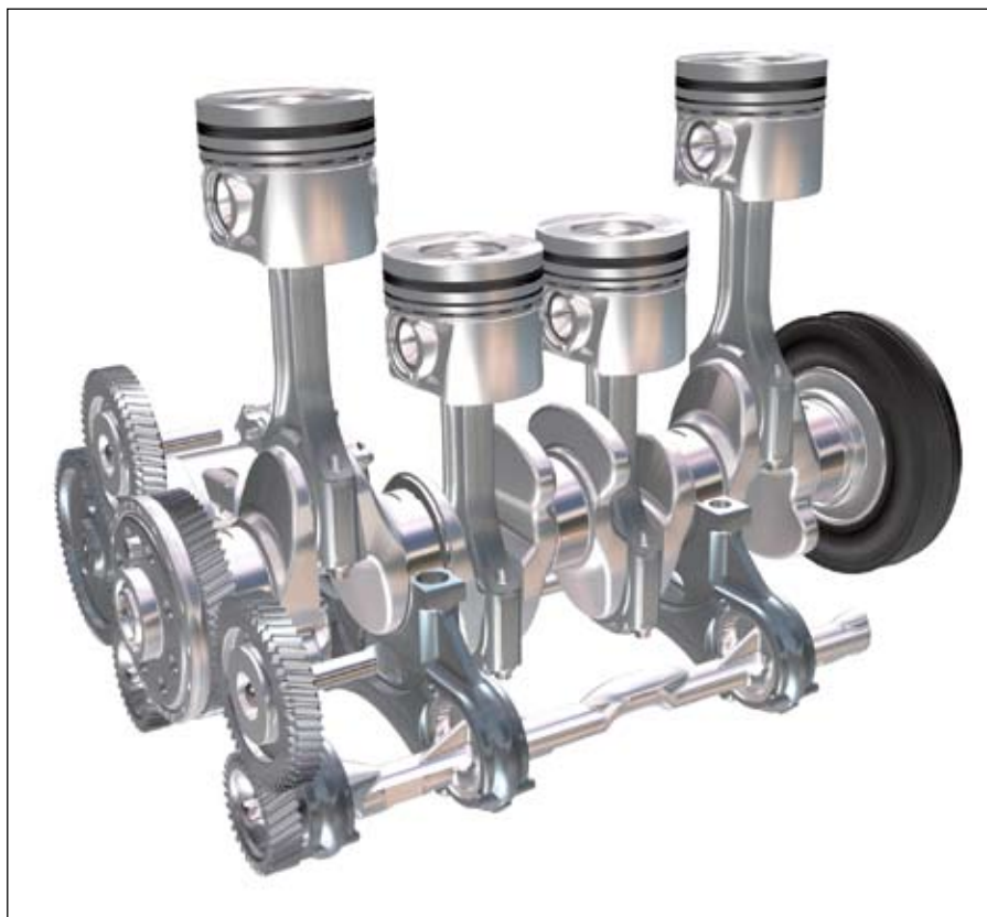
3. ábra: a forgattyús mechanizmus a tűgörgős ágyazású Lanchester-tengelyekkel
