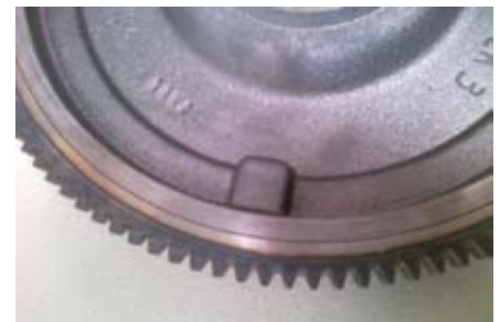
6. ábra: tömeg-aszimmetrikus lendkerék alkalmazása az alternáló erők vízszintesebbé fordításához
