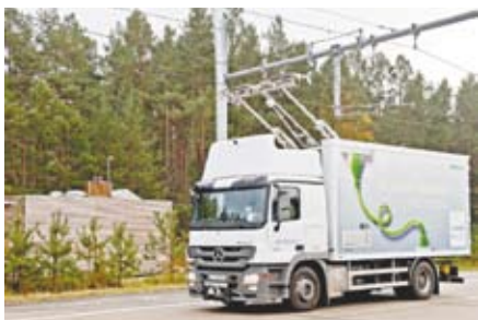
A Siemens terve szerint a német autópályák szélső sávja fölött villamos felsővezeték építenének ki az áruszállítás villamosítására, amelyről a tehergépkocsik, áramszedőn keresztül juthatnának töltőáramhoz
