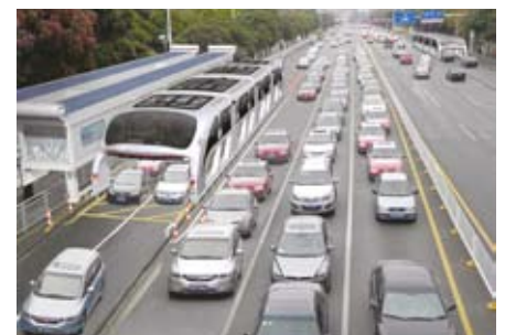
Kínai terv az autóbuszok utasbefogadó képességének növelésére: magas busz, amelynek utastere alatt a megállóhelyi beszállások idején és a jármű haladása közben is akadálytalanul folyhat a kétsávos személyautó-forgalom
