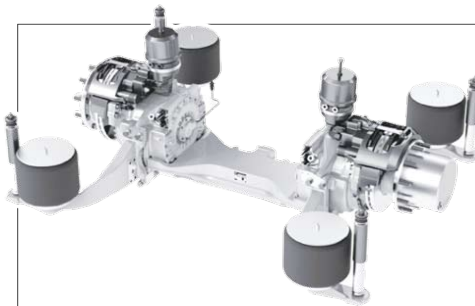
A nagy befogadóképesség egyebek között a második és harmadik tengely kerékagymotor-hajtásának köszönhető, melyeket lefelé eltolt légrugós merev tengely hordoz
