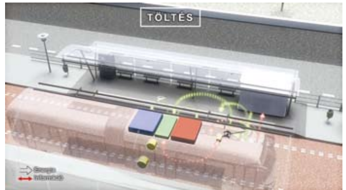
...úgy, hogy az akkumulátorokat a le-felszállás időtartama alatt tölténék fel, a következő megálló eléréséhez szükséges töltőárammal
