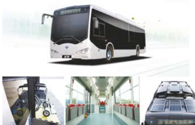
Villamos hajtású kínai BYD eBUS-12 BYD K9-es autóbusz és jellegzetes részletei: tolokocsirámpa; utastér, felhajtható és fix ülésekkel; tetőn elhelyezett napelemek
