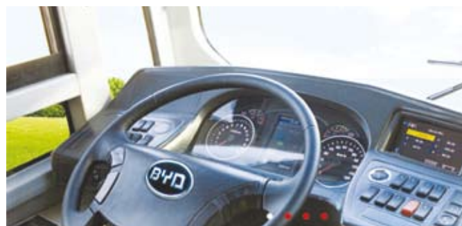
A BYD eBUS-12 BYD K9-es autóbusz műszerfalának középső kijelzőjén nemcsak az együttes cellafeszültség, hanem a meghibásodott cellák is megjeleníthetők
