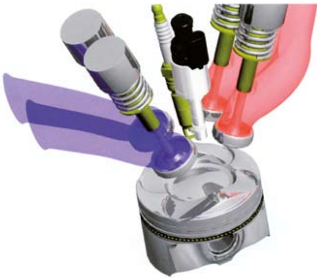
16. ábra: a szívócső és a dugattyútető kialakítása a homogén keveredést szolgálják
