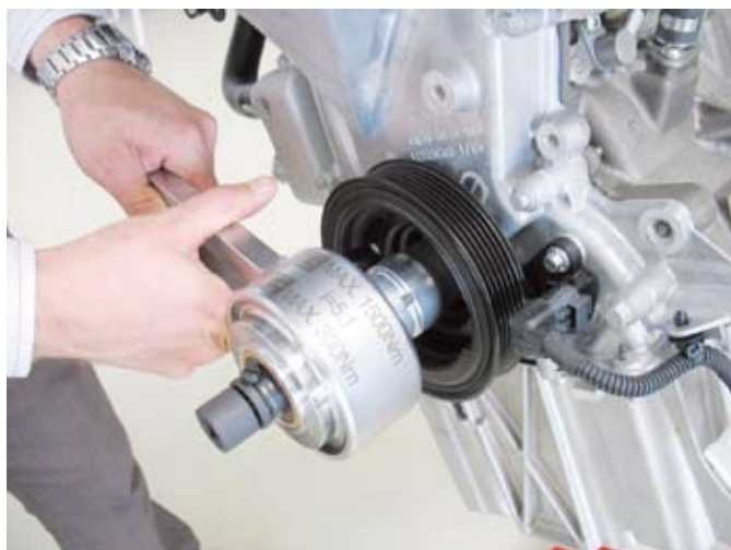
8. ábra: az ékszíjtárcsacsavar meghúzása nyomatéktöbbszöröző segítségével
