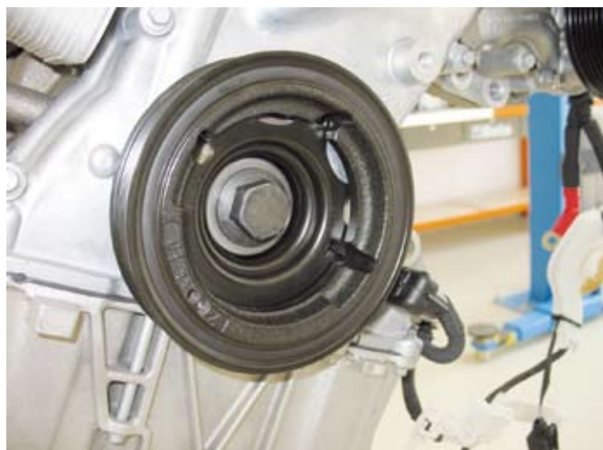
6. ábra: gumis lengéscsillapító az ékszíjtárcsába építve
