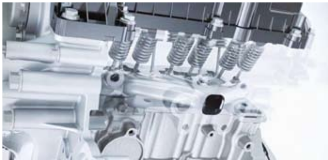
12. ábra: az integrált kipufogócsonk elhelyezkedése a hengerfejben
