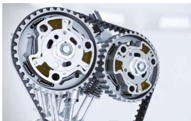
10. ábra: a mindkét oldalon állítható szelepezérlés működése
