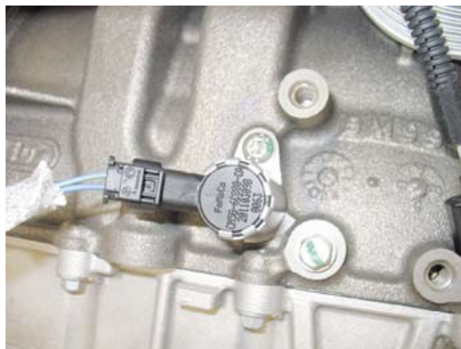
22. ábra: az olajnyomást szabályozó mágnesszelep a blokk oldalához van rögzítve
