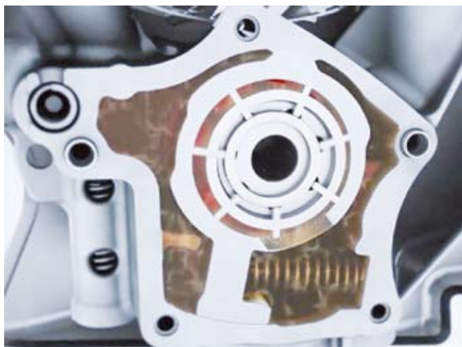
21. ábra: az olajszivattyú kialakítása az állítható gyűrűvel és nyomórugóval
