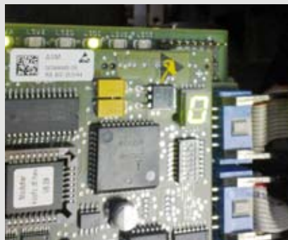
ESD-érzékenység jelölése áramköri panelen
