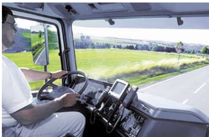
A FleetBoard fedélzeti eszközei Mercedes-Benz tehergépkocsi vezetőfülkéjében
