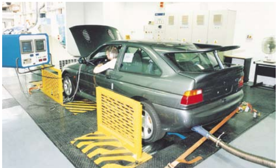
Görgős terhelőpadon végzett emisszióvizsgálatok során a jármű menetellenállási előírt határok között változtathatók
